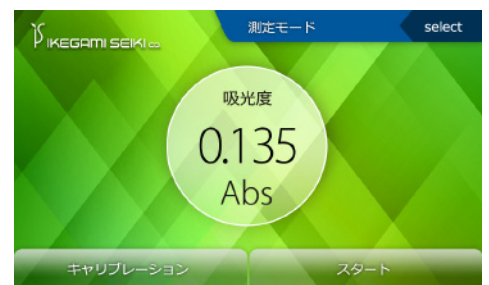
測定モード：吸光度を測る
